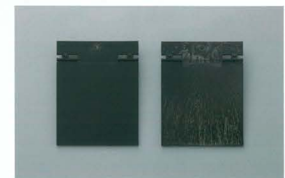
未乾燥ポリカーボネート/ABS ベント式成形品 未乾燥ポリカーボネート/ABS ノンベント式成形品
